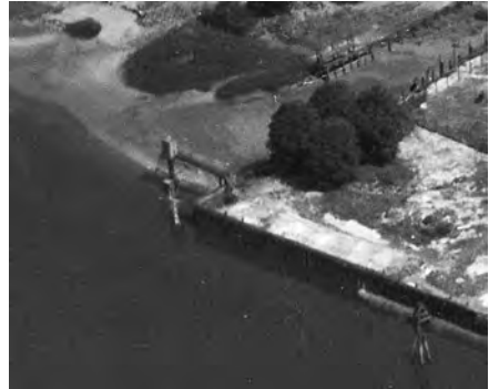
Luftaufnahme vom Farger Weserufer bei der Witteburg vom 8. Juni 1929 (Ausschnitt). In Übereinstimmung mit der Skizze (Abb. 7) erkennt man das auf einem Gerüst stehende Pegelhäuschen sowie die Brücke, die es mit dem Bollwerk verband. Quelle: Staatsarchiv Bremen, StAB 10.B FS 30 62-004.
